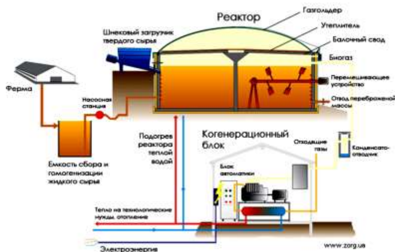
Схема работы биогазовой установки.
